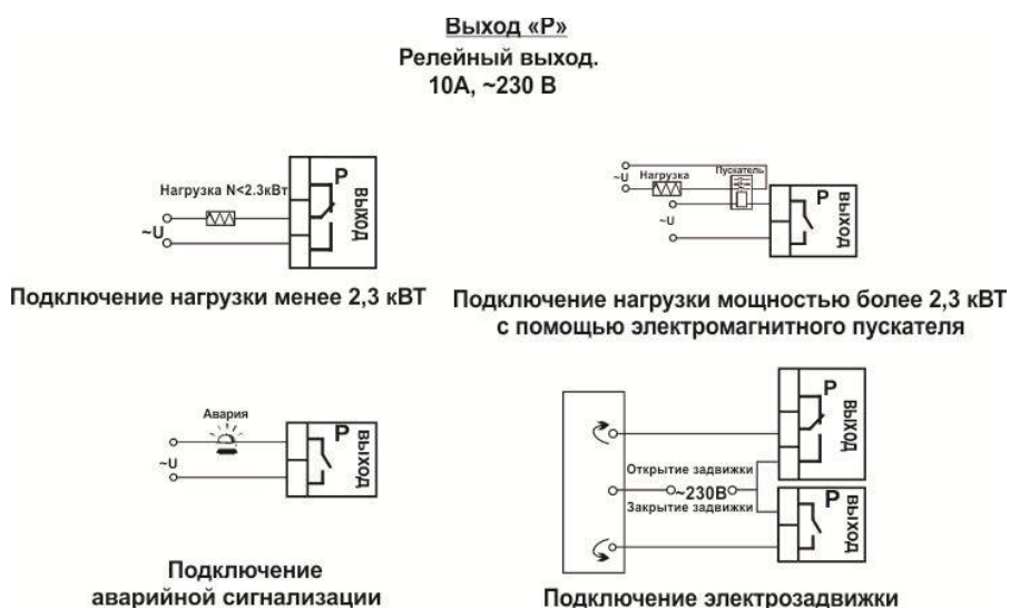
Рисунок 4 – Схемы подключения релейного выхода
